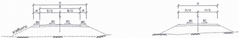
รูปแปลนแสดงการยกระดับผิวจราจรแบบ NORMAL CROWN
