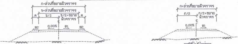
รูปตัดแสดงการยกระดับแบบ HALF CROWN
